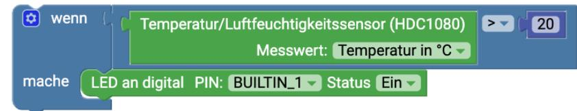
Beispiel: **Wenn** die Temperatur größer als 20°C ist, **dann** wird die eingebaute LED angeschaltet.
