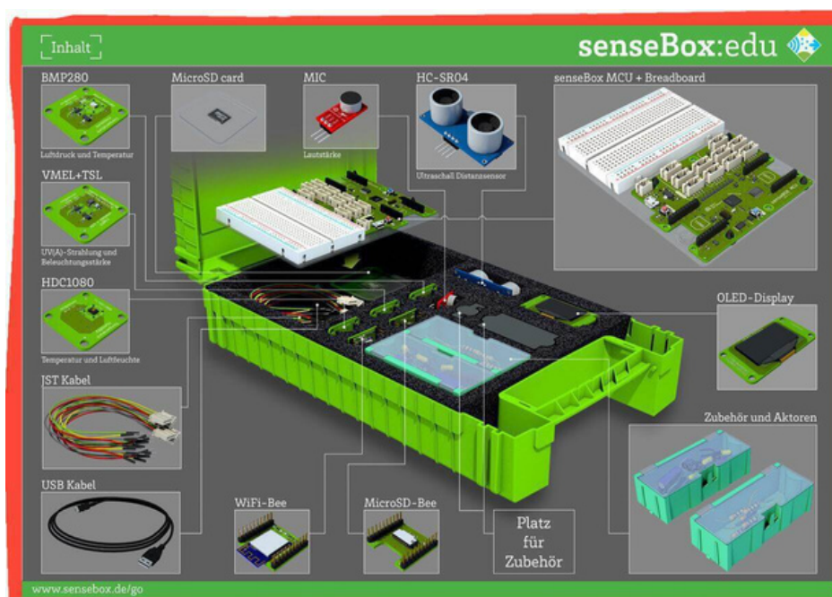
Abb. 7: Die senseBox:edu hält als offener Werkzeugkasten viele Optionen zum Lernen und Experimentieren bereit
